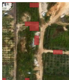
איור 85 - אינדיקציה לשינוי מרקם קרקע ממדד Sbc Sentinel-2 (צבע אדום). רקע: Maxar Technologies 2024
